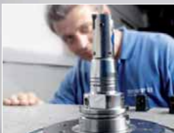
Wohlhaupter Präzisionswerkzeuge sind grundgewuchtet. Auf Kundenwunsch werden sie feingewuchtet.
