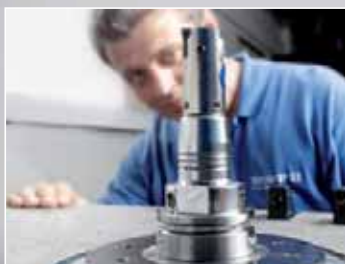
Wohlhaupter-tarkkuustyökalut on perustasapainotettu. Asiakkaan pyynnöstä ne hienotasapainotetaan.
