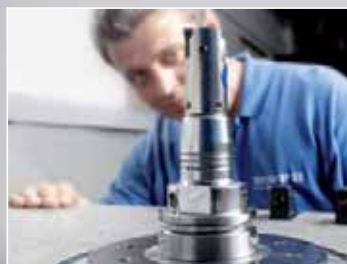
Wohlhaupter precíziós szerszámok alapkiegyensúlyozással rendelkeznek. Ügyfélkívánságra finomkiegyensúlyozásra kerülnek.
