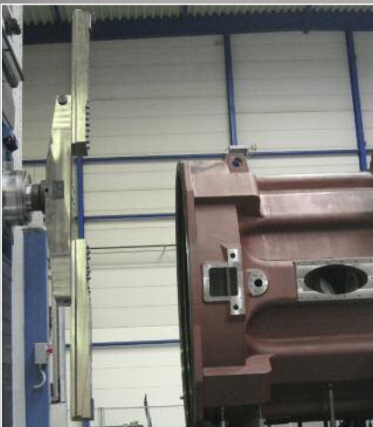
Fertigbearbeitung eines Gussgehäuses EN-GJL-250: \varnothing 870^{H7} , V_c 400 m/min., Bearbeitungslänge 1700 mm, Schneidstoff WBN 300, Bearbeitungszeit: 103 Min.
