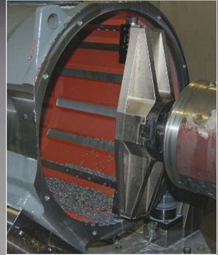
Statorgehäuse EN-GJS-500-7: Vor-/Fertigbearbeitung Combi-Line \varnothing 409,5^{P7} , Bohrungstiefe: 500 mm, stark unterbrochener Schnitt
