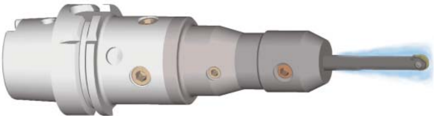
Grundaufnahme HSK-A63 / Reduzierung / Zwischenhülse mit innerer Kühlmittelzufuhr / Schaftfräser
