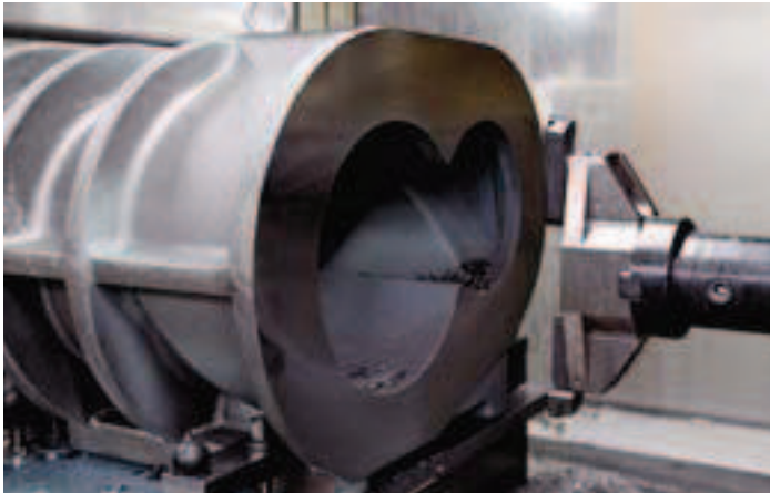
Gussgehäuse mit zwei offenen, ineinander laufenden Bohrungen vor der Bearbeitung
