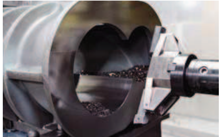
Das Schraubenkompressor-Blockgehäuse nach der Bohrungsbearbeitung
