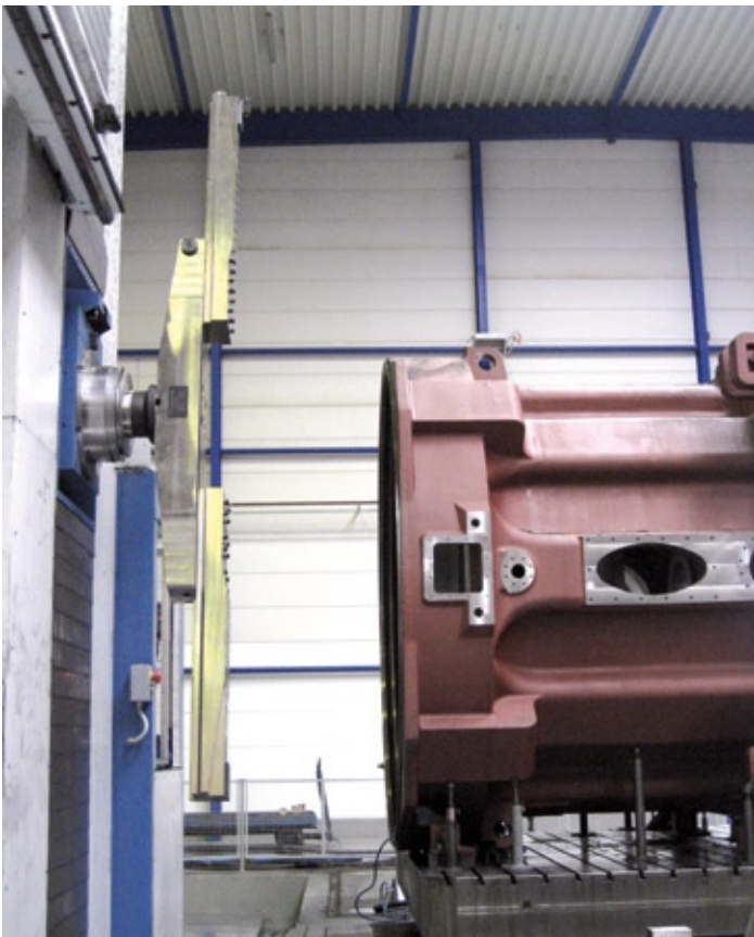
Mit einem Bearbeitungsdurchmesser 2335 mm ist das bei der Firma DMR, Rostock eingesetzte Werkzeug das größte je von Wohlhaupter gebaute Werkzeug.
