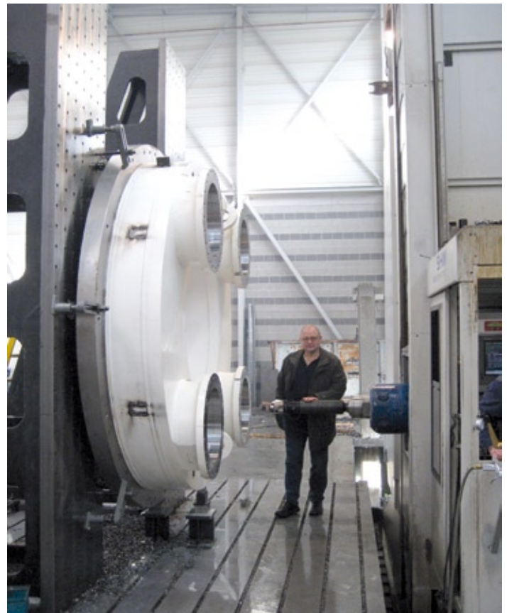
Bearbeitung eines Schweißteiles aus St 52 Schlichtbearbeitung Durchmesser 225 H7, schwingungsgedämpft, Auskräglänge 680 mm.
