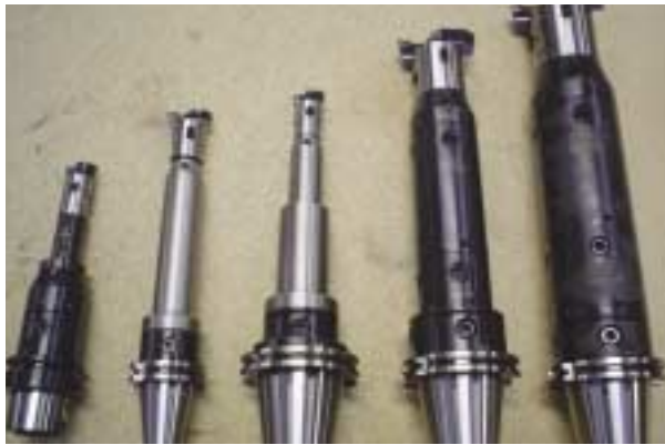
Breite Palette: Kral setzt inzwischen die CombiLine-Ausdrehwerkzeuge von Wohlhaupter in den verschiedensten Größen ein.
