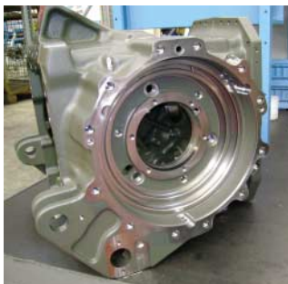
Schruppen und Schlichten: Hinterachsgehäuse für einen Traktor 300er Vario. Die Bearbeitung der Bohrungen mit einem Durchmesser bis zu 318 mm erfolgt mit 15 Wohlhaupter-Bohrstangen.
