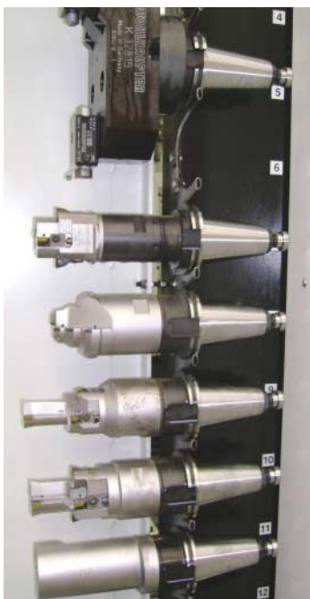
Sonderbohrstangen von Wohlhaupter: Fertig zur Bearbeitung des Hinterachsgehäuses auf einer StarragHeckert HEC 630.
