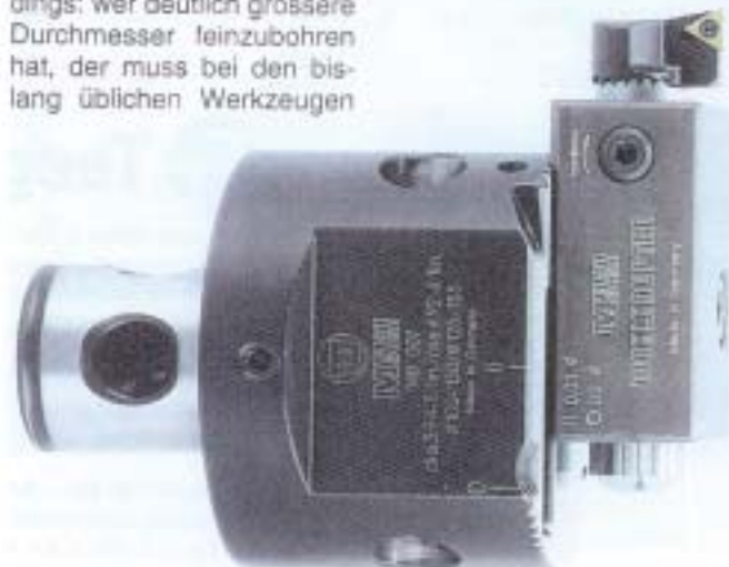
Das war der Anfang der Leichtbauweise: universelles Feindreh-Werkzeug mit neuem Gehäuse aus (hochfestem, aber eben leichtem) Aluminium...
