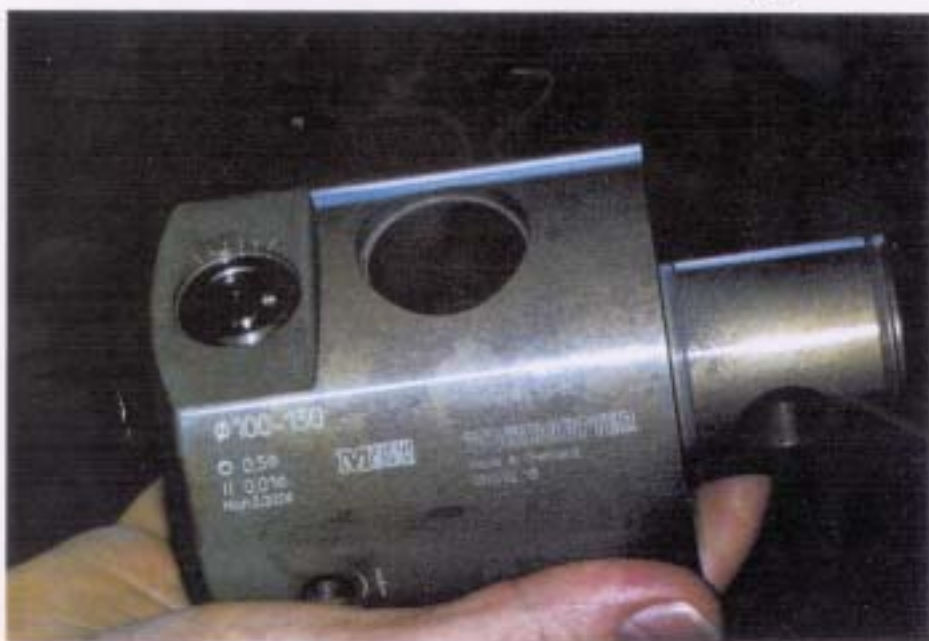
Bild 1: Rein vom Äußeren her kann man die neuen „Wohlhaupter“ nicht von ihren stählernen und weit schwereren Geschwistern unterscheiden. Doch bieten sie einige Vorteile, wie etwa HSC-Tauglichkeit, wobei die Garantie bis 3000 m/min nicht so streng zu nehmen ist.
