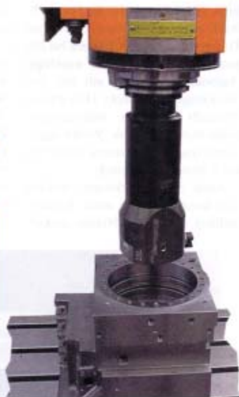
Vom Standard zur Sonderlösung: Bei diesem Feindrehwerkzeug konnte das Gewicht unter 25 kg reduziert werden; damit kann es automatisch eingewechselt werden und reduziert die Nebenzeiten deutlich.
